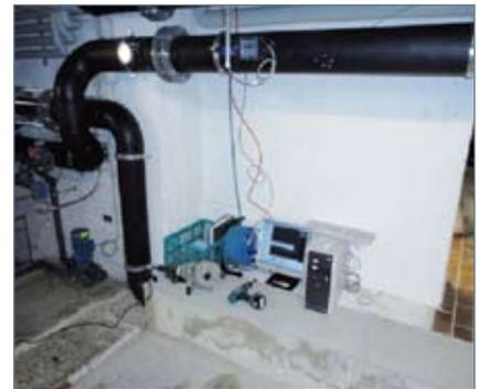
■ Versuchsaufbau der Firma Wassertechnik Wertheim. Kontinuierlich wurden gemessen und aufgezeichnet bzw. per Remote Access abgerufen: Mengendurchfluss, Energieverbrauch an beiden Frequenzumformern, per Hand Druckmessungen
