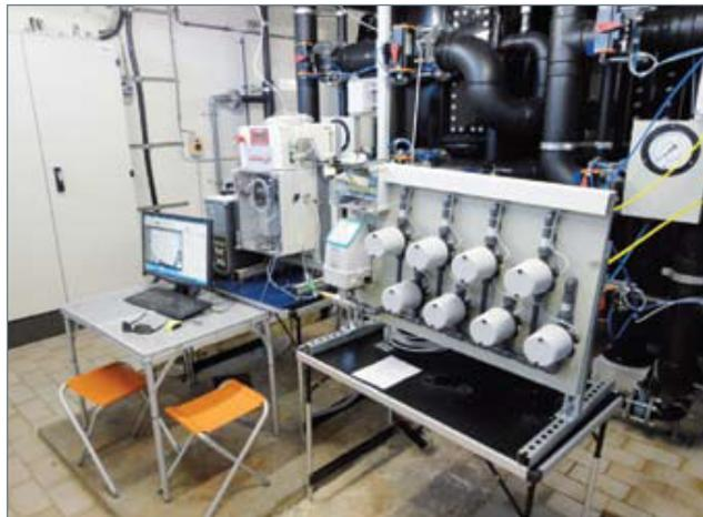
■ Versuchsaufbau des Ingenieurbüros für innovative Wassertechnik (IWT), Hannover. Kontinuierlich wurden gemessen und auf gezeichnet bzw. per Remote Access abgerufen: Partikelanzahl, Partikelgröße, Mengendurchfluss; im Bild zu sehen: acht Membranventile zur Umschaltung der Kanäle
