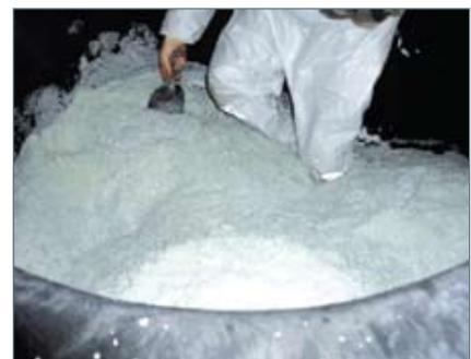
■ Trockeneinbringen der Glaskugeln, absolut staubfrei
