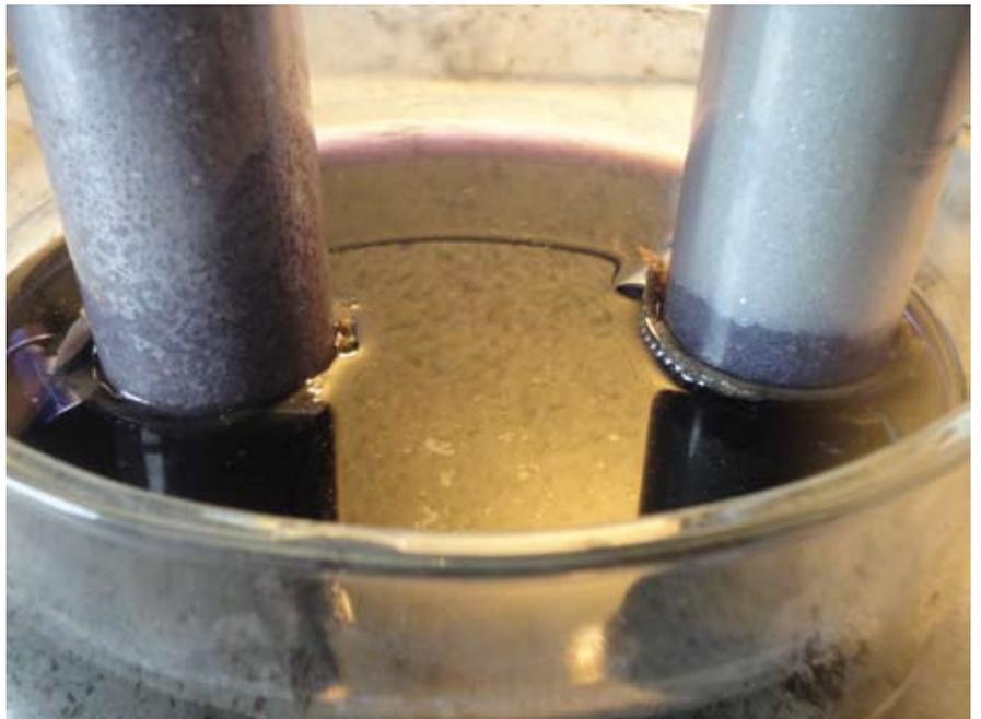
■ Kapillarer Aufstieg – links: Sand, rechts: Glaskugeln
